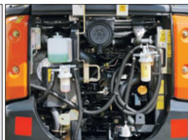
Le nouveau moteur offre puissance et vitesse avec moins de bruit. Le circuit hydraulique à trois pompes éprouvé permet d'effectuer des opérations combinées sans à-coups. La ZX18-3 est équipée d'un train de chenilles rétractable dont les dimensions vont de 970 à 1 280 mm : replié pour un travail efficace dans un espace exigü et déployé pour davantage de stabilité.
