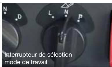
Mode P : Fouille travaux lourds Mode N : Chargement Mode L : Opérations légères
