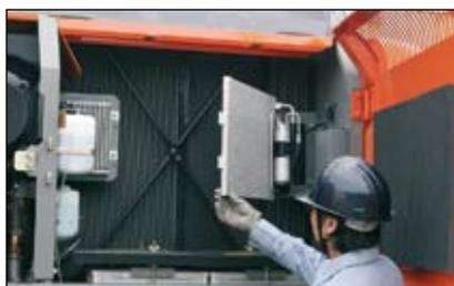
Le refroidisseur d'huile, le radiateur et l'échangeur sont disposés en parallèle au lieu de l'installation conventionnelle en série. Cette disposition en parallèle offre d'importants avantages quant au nettoyage autour du moteur. Le condensateur du climatiseur s'ouvre pour permettre de nettoyer facilement le condensateur et le radiateur placé derrière.
