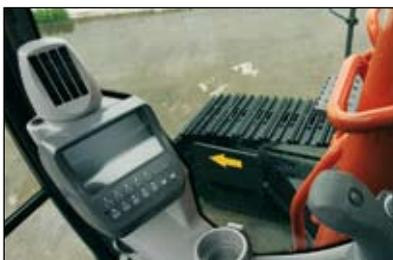
Le moniteur couleur à cristaux liquides, placé dans la cabine, indique la température du liquide de refroidissement, le niveau de carburant et certaines données d'entretien. Il permet aussi le réglage tactile de l'outil. L'écran peut également être réglé pour le travail de jour ou de nuit.
