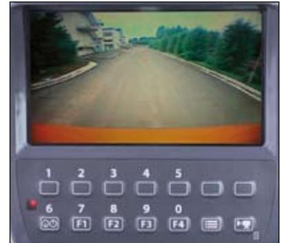
Le moniteur couleur grand-écran LCD vous permet également de voir ce qui se passe à l'arrière de l'engin, au bénéfice d'une meilleure sécurité pendant la rotation et le déplacement. La rétro-caméra, placée dans le contre-poids, peut être manuellement mise en marche à l'aide du sélecteur placé sur le moniteur. De surcroît, cette fonction est automatiquement activée pendant le déplacement de l'engin.
