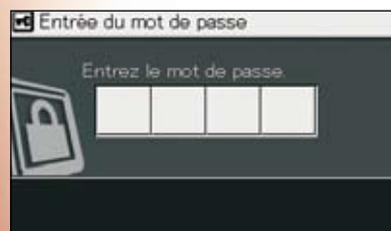
Au démarrage du moteur, l'immobilisateur électronique demande systématiquement l'introduction d'un code de cryptage dans le moniteur multifonctionnel pour éviter le vol et le vandalisme.
