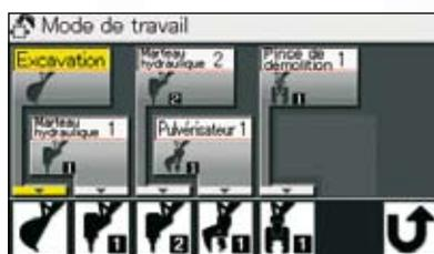
Quand on change d'outil, le réglage du débit d'huile peut être réalisé automatiquement par sélection du mode de travail sur le moniteur LCD. Des ajustements mineurs du débit sont possibles si besoin est.
